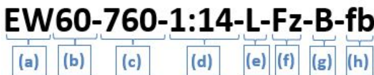
Figure 2.23: Nomenclatura de desvíos en la administración ferroviaria alemana
