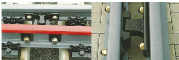
Figure 2.32: Vista general del dispositivo antideslizante horquilla-muñon FUENTE: Estudio de la evolución de los desvíos ferroviarios [10]
