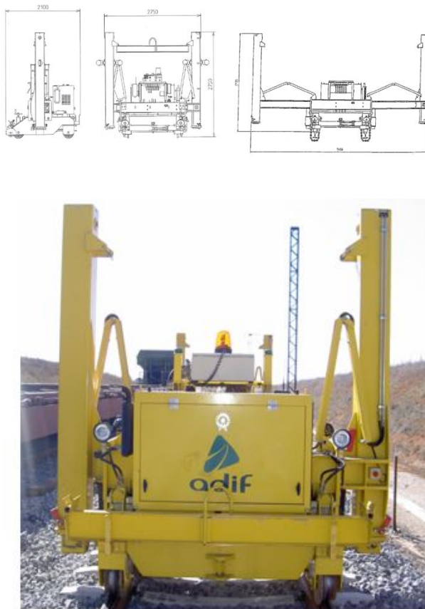
Figure 2.85: Sistema modular PEM/LEM. Detalles y vista general del pórtico extensible motorizado (PEM)
