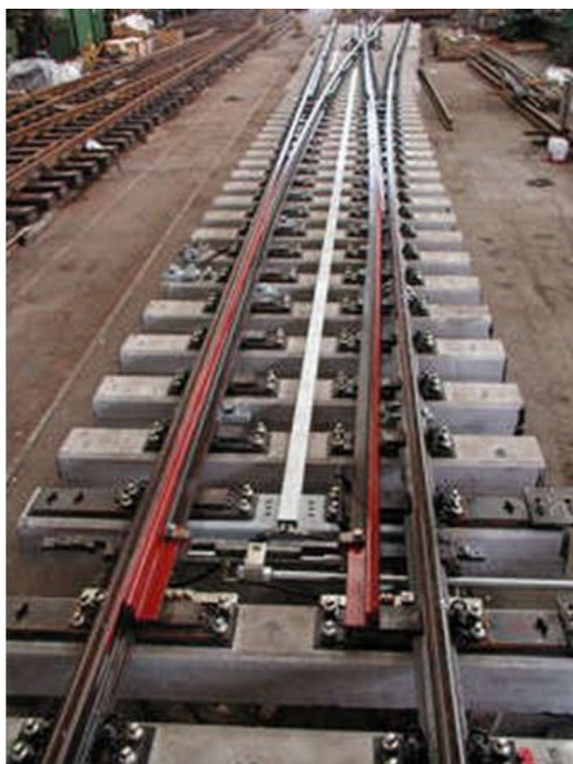
Figure 2.53: Sistema de transmisión hidráulica Hydrolink® FUENTE: JEZ Sistemas Ferroviarios,S.L.
