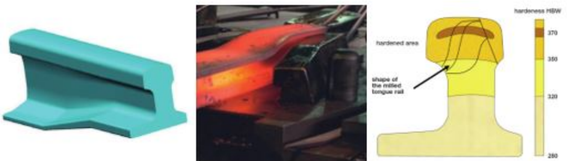
Figure 3.76: Mecanizado de las agujas móviles de los aparatos de dilatación FUENTE: Catálogo Rail Movement Joints. Voestalpine GmbH (Voestalpine GmbH)
