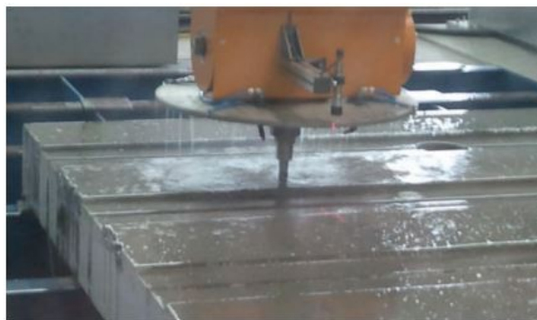
Figure 2.147: Perforación de los orificios donde irá alojada la sujeción del carril a la placa mediante un sistema de perforación computarizada de alta precisión en taller.
