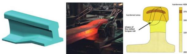
Figura 2.17: Mecanizado de las agujas móviles de los aparatos de dilatación, (FUENTE: Catálogo Rail Movement Joints. Voestalpine GmbH [21])
