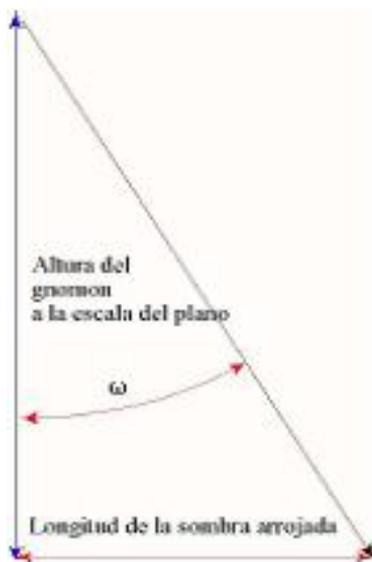
Figura 3.16: Longitud de la sombra arrojada por un gnomon a la escala del plano de estudio conociendo la altitud solar (Fuente: [22])
